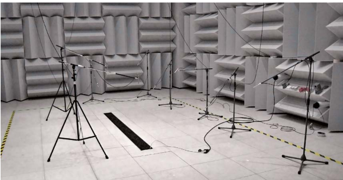
Chambre de mesure acoustique
